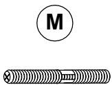
x8 Hanger bolt \phi 5/16 "-18 x 88mm * x8 Boulon-vis \phi 5/16 "-18 x 88mm x8 Perno de suspensión \phi 5/16 "-18 x 88mm
